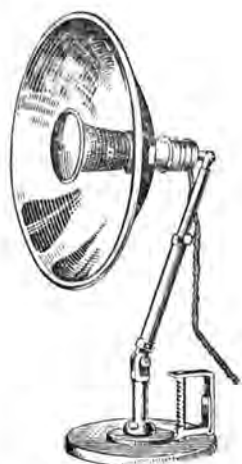
Рис. 281. Лампа инфракрасных лучей.
