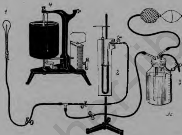
Рис. 258. Токодинамометр Schatz'a в модификации Малиновского. 1 — Вводимый в матку баллон. 2 — Манометр с системою трубок и пером. 3 — Прибор для наполнения трубок жидкостью и для выкачивания воздуха из всей системы. 4 — Кимограф.
