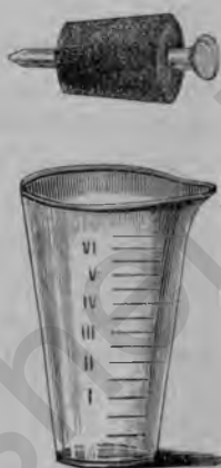
Рис. 206 Мензула для опредѣленія количества смѣси, сверху—пробка со штифтомъ.
