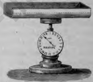
Рис. 79. Пружинные вѣсы для взвѣшивания маленькиихъ дѣтей. На днѣ корытоподобной чашки наклеенъ сантиметръ.
