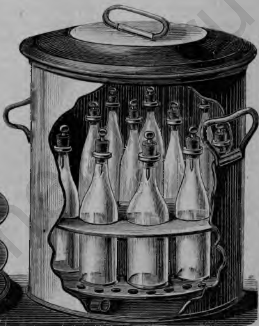
Рис. 204. Кастрюля Соклета со вложеннымъ въ нее штативомъ передъ кипяченіемъ.
