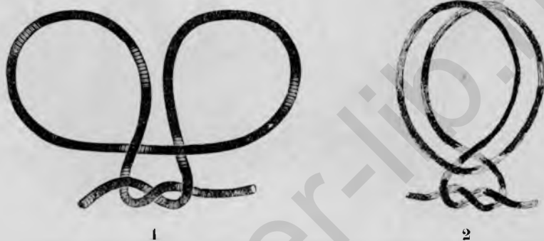
417. 1.— Стаффордшайрский узел — схема. 2.— Стаффордшайрский узел (модификация автора). Он образует двойную перекрещивающуюся петлю.
