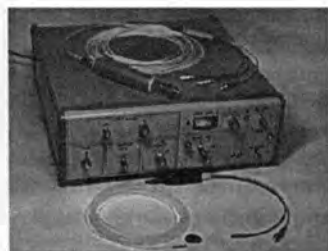
Рис. 1. Оптический когерентный томограф со сменными эндоскопическими зондами. Размеры прибора: 15×40×40 см, вес 10 кг
