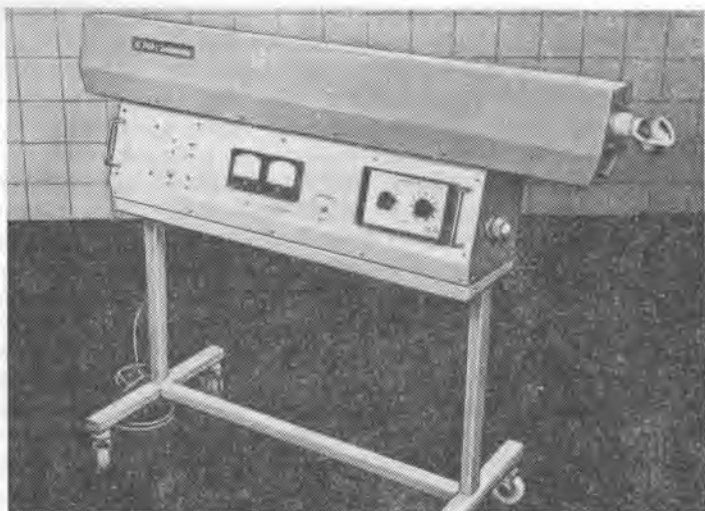
Рис. 1. Общий вид оптического квантового генератора типа ЛГ-75 (генератор включен)
