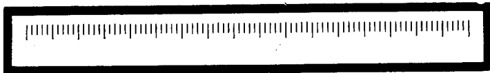
Рис. 22. Металлическая линейка с нанесенными на нее (методом прорези) цифровыми делениями на расстоянии 1 см. Каждое деление разделено на 5 равных частей.
