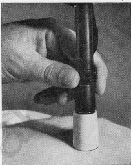
21а. Ультразвуковой датчик для работы в импульсном режиме диагностического прибора «Laminograph» фирмы «Parker». (изображение ультразвукового поля датчика см. на рис. 14, а).
