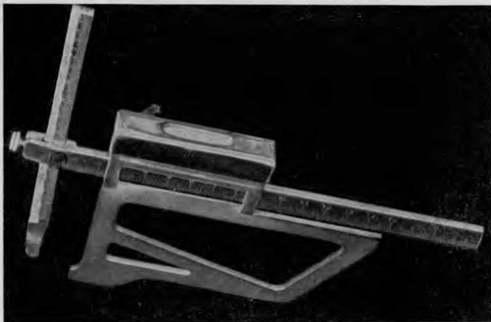
Рис. 51. Общий вид дистометра Мошкова.
