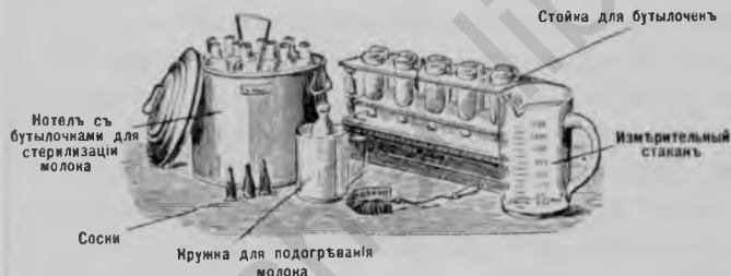
Аппаратъ-стерилизаторъ проф. Сокслета для дѣтскаго молока.
